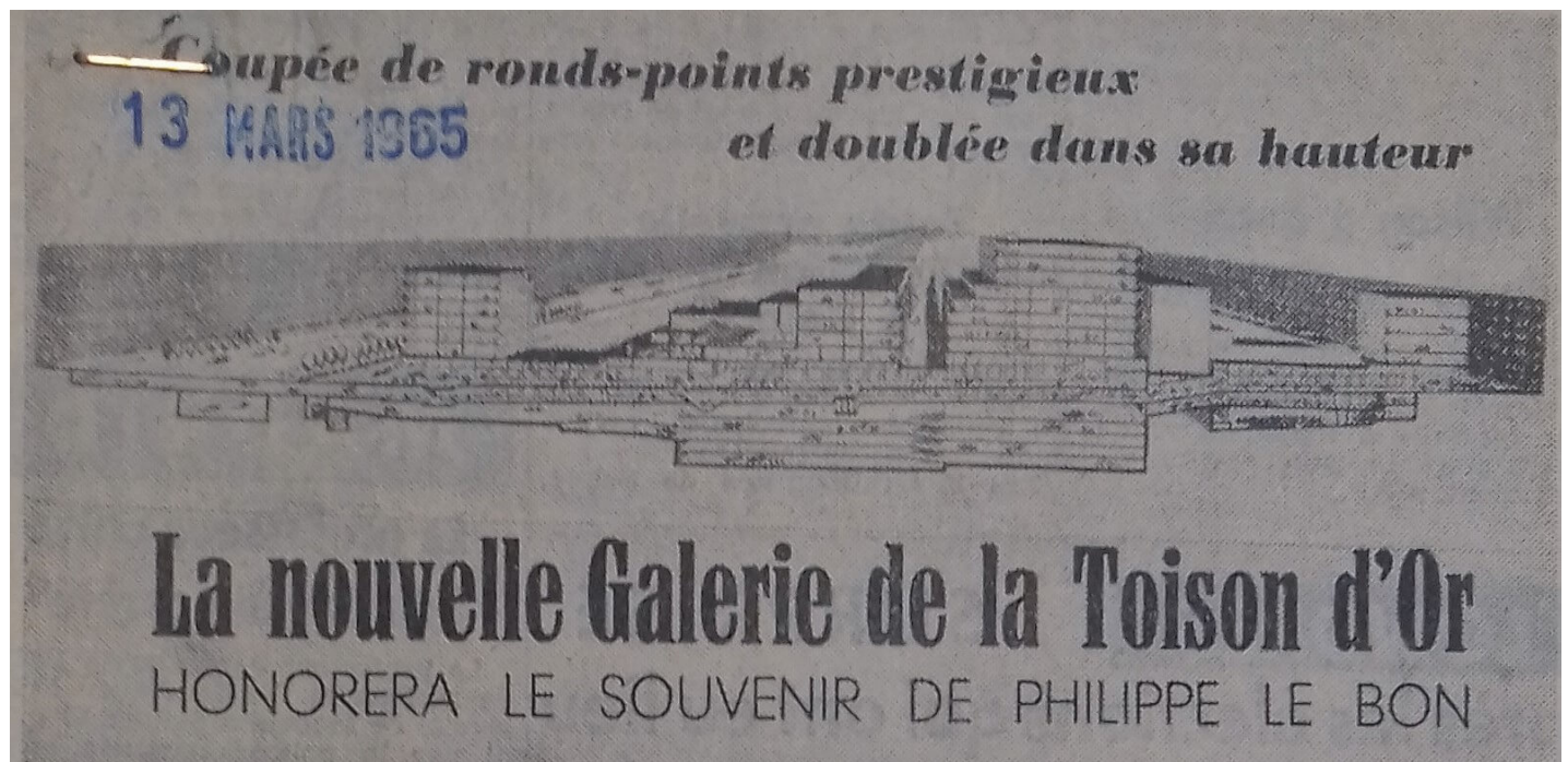
Figure 4 Coupe perspective de la Galerie Toison d'Or illustrant la démultiplication des niveaux de sol et la fine connexion des infrastructures de mobilités rapides avec le complexe architectural (accès métro, parking, tunnel autoroutier). Source : André Hustin, « La nouvelle Galerie de la Toison d'Or honorera le souvenir de Philippe le Bon. Coupée de ronds-points prestigieux et doublée dans sa hauteur », 13 mars 1965, p.1. © KBR.
